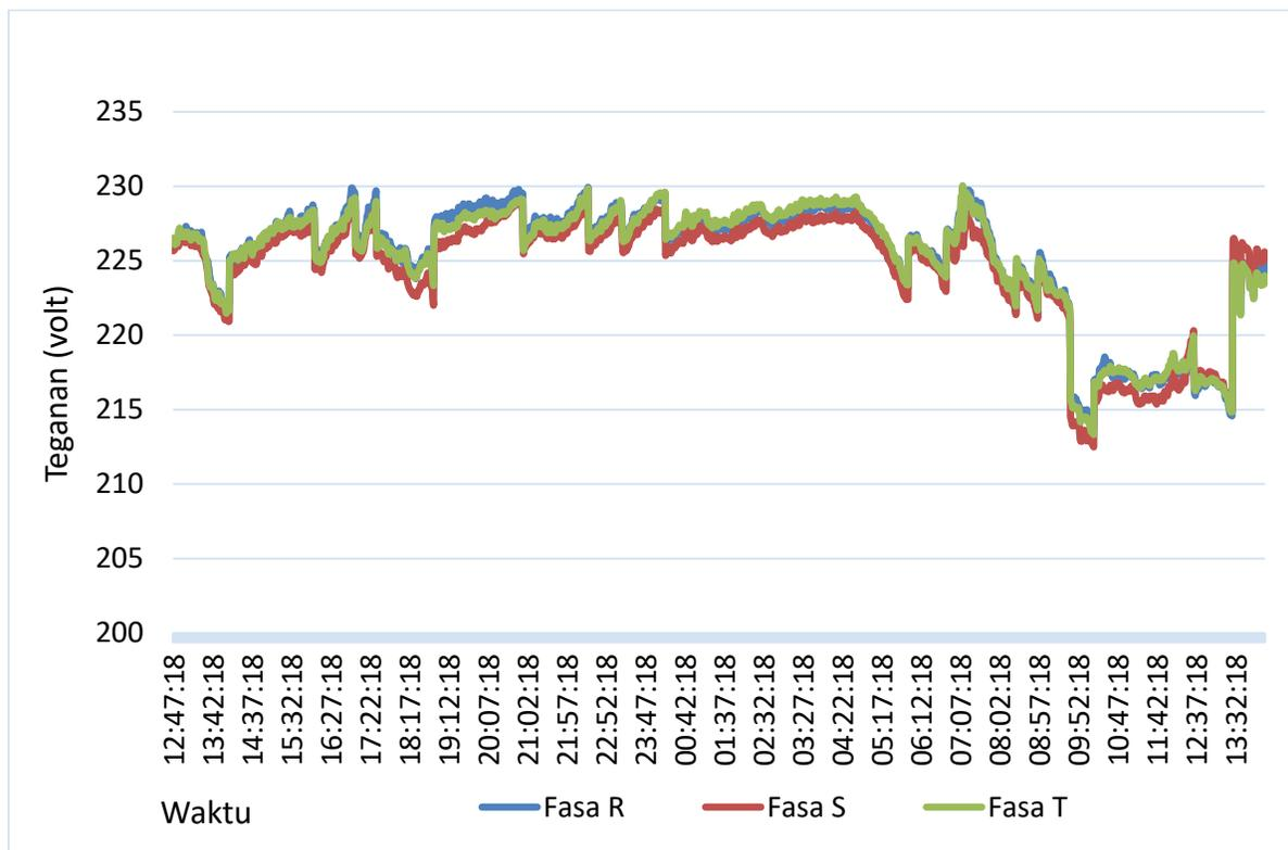
Gambar 5.1.1.1b. Profil Tegangan Fasa pada Panel MDP 66 kVA
