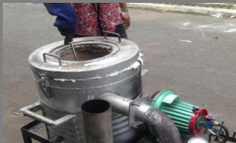
Daur ulang limbah aluminium dari praktikum lab Teknik mesin
